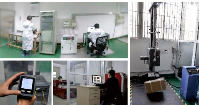
整机性能实验：温升实验，短路性能测试，过载性能测试，电流采样精度测试，功率因素与效率测试等.....
