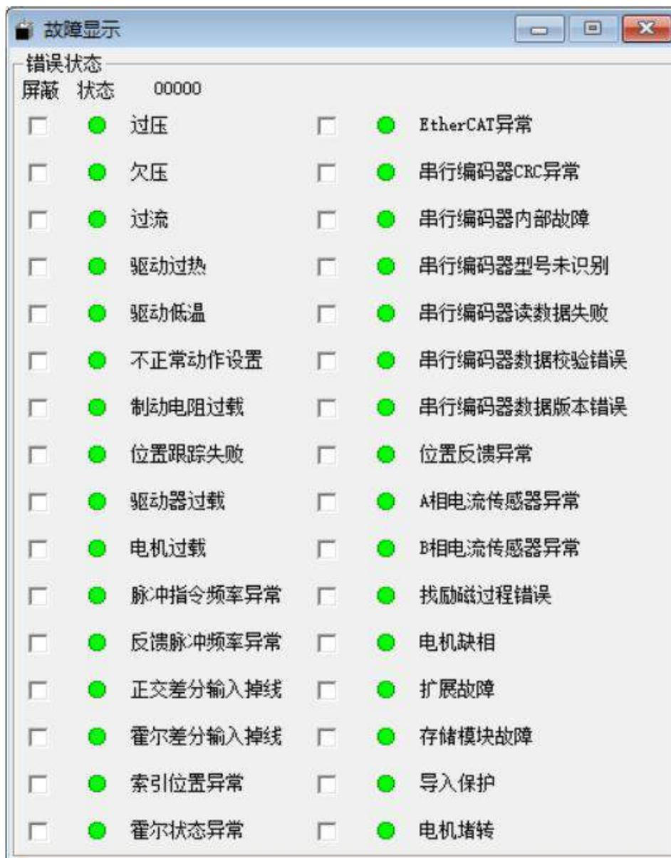
点击驱动器 D→历史故障，可查看最近 8 次故障组信息，记录的故障组错误次数值越大，故障发生时间越近
