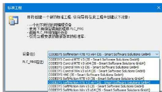
工程建好后，在桌面右下角找到 CODESYS Softmotion RTE V3 x64 控制组件，右键→Start PLC
