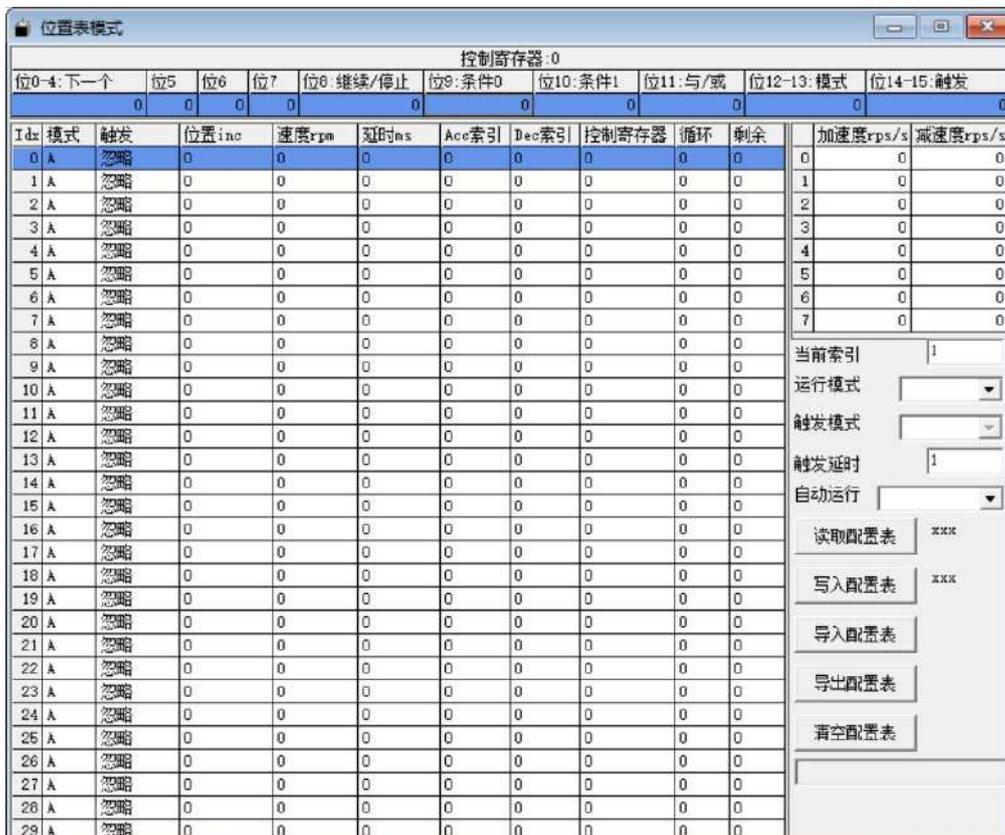
位置表模式是用于位置控制的一种功能，可在该模式下运行多达 32 个独立任务。每个任务包含多个关键参数信息，例如目标位置、运行速度、加速度和减速度等。此外，任务还包括是否在任务完成后继续执行下一个任务的指令、下一个任务的索引值、下一个任务执行的触发条件，以及任务的最大循环次数等设置。
