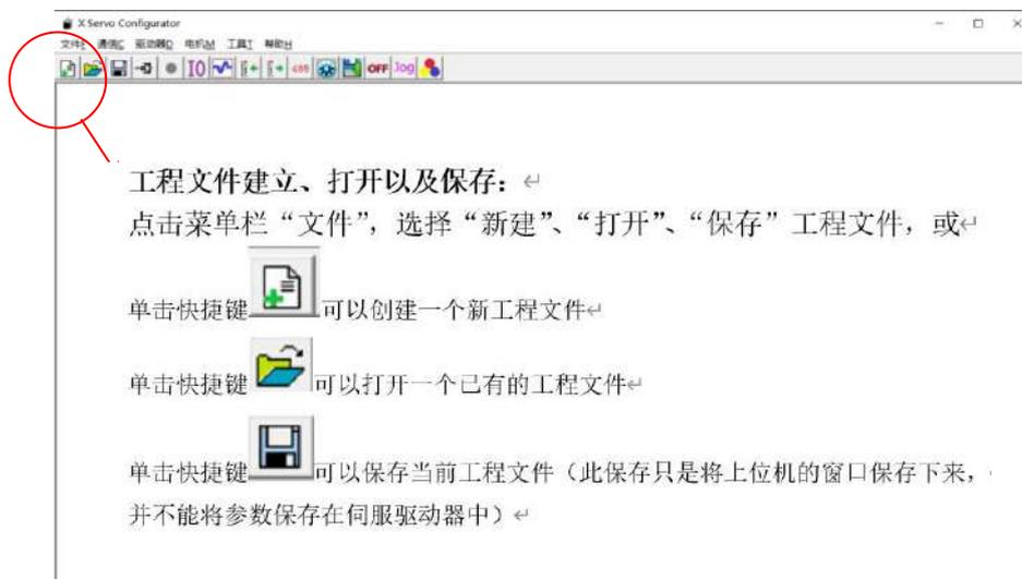
建立工程文件后，在菜单栏中找到通信，点开通信设置进行通信连接，点击串口下拉栏选择 USB 串口或点击刷新自动识别串口，选择合适通讯波特率（默认 256000）和通信 ID（默认 127），点击打开即可连接（上位机可设置 ID 为 127 连接未知通信 ID 的驱动器）
