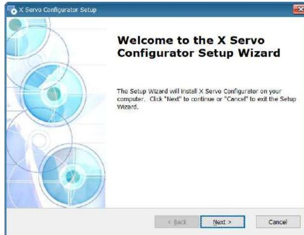
点击“Next”，下一步，安装过程中用户可自定义安装路径，默认安装路径为“C:\Program Files(x86)\X Servo Configurator\”。选择好安装路径后，点击“Next”，进行下一步
