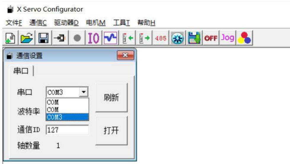
正常连接后，通讯设置按键会显示绿色，如下所示，伺服驱动器与上位机建立通信以后可以通过单击
