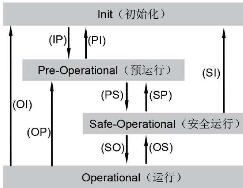
从初始化状态向运行状态转化时，必须按照“初始化→预运行→安全运行→运行”的顺序转化，不可以越级。从运行状态返回时可以越级转化。状态和状态转化操作如下表所示：
