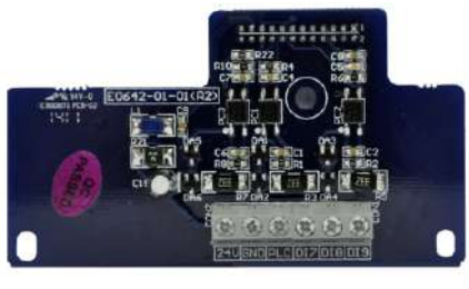
IOV-D112适用于DX系列变频器
