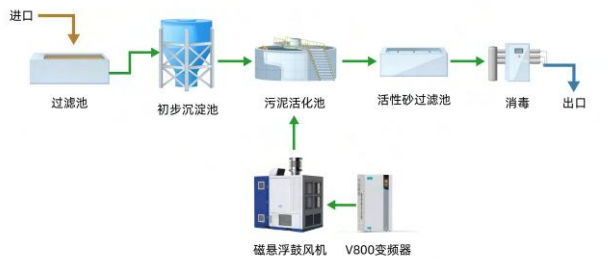
图1 市政污水处理工艺流程
